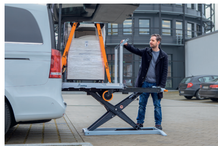
Ved hjælp af et håndtag frigives pladen med teleskopudtræk, og selve vognen køres ind i bilen. Herefter køres sakseliffen op og skubbes ind under vognen igen.
